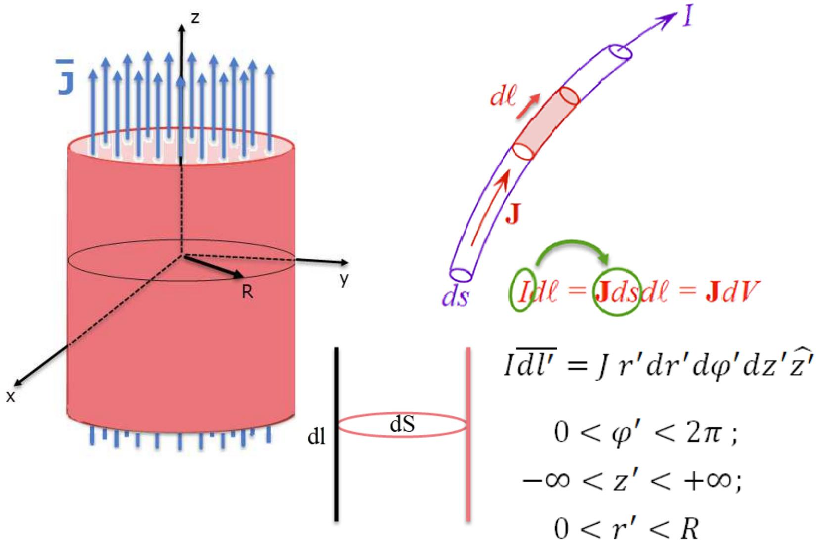
3) Otro ejemplo: calcular el campo en el eje  $y$  para la siguiente distribución:
