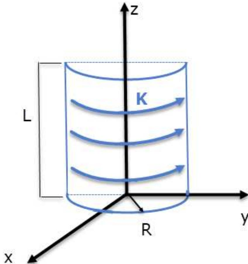
2) Otro ejemplo: calcular el campo en el eje z para la siguiente distribución:
