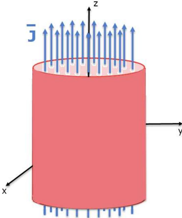
3) Otro ejemplo: calcular el campo en el eje y para la siguiente distribución:
